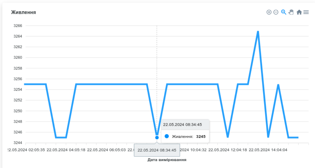
Рисунок 3.12 – Графік напруги батареї живлення в мВ протягом вимірювання
