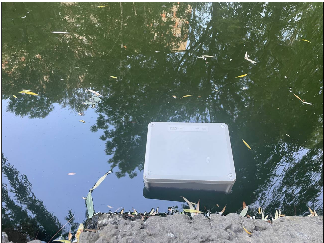
Рисунок 3.3 – IoT-пристрій для вимірювання якості поверхневих вод
