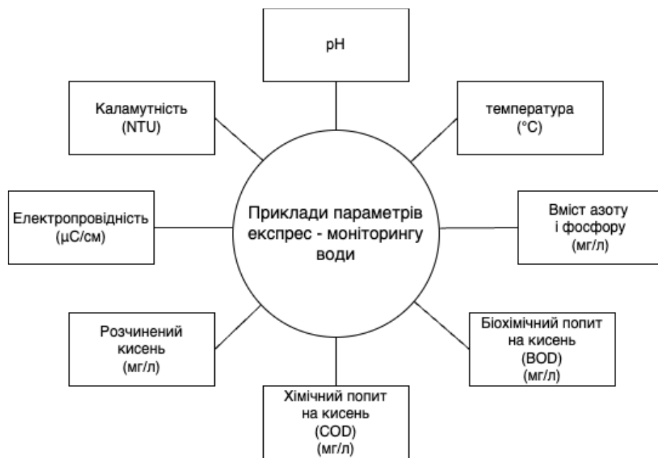
Рисунок 2.1 – Класифікація параметрів моніторингу води
