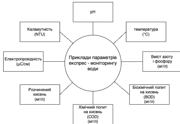
Рисунок Г.1 – Класифікація параметрів моніторингу води
