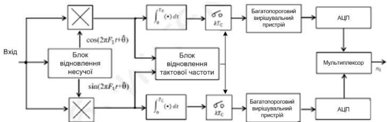
Рисунок 2.11 – Структурна схема когерентного демодулятора КАМ-сигналів
