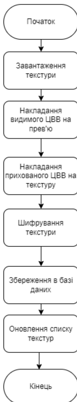
Рисунок 2.1 – Алгоритм роботи модуля захисту
