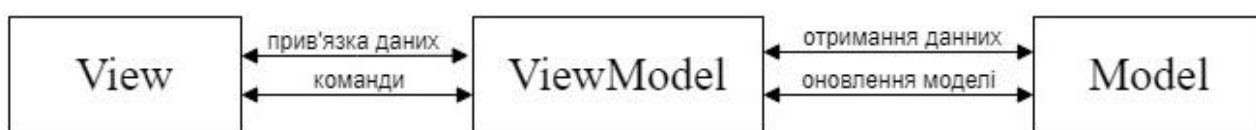
Рисунок 3.1 – Компоненти паттерну MVVM
