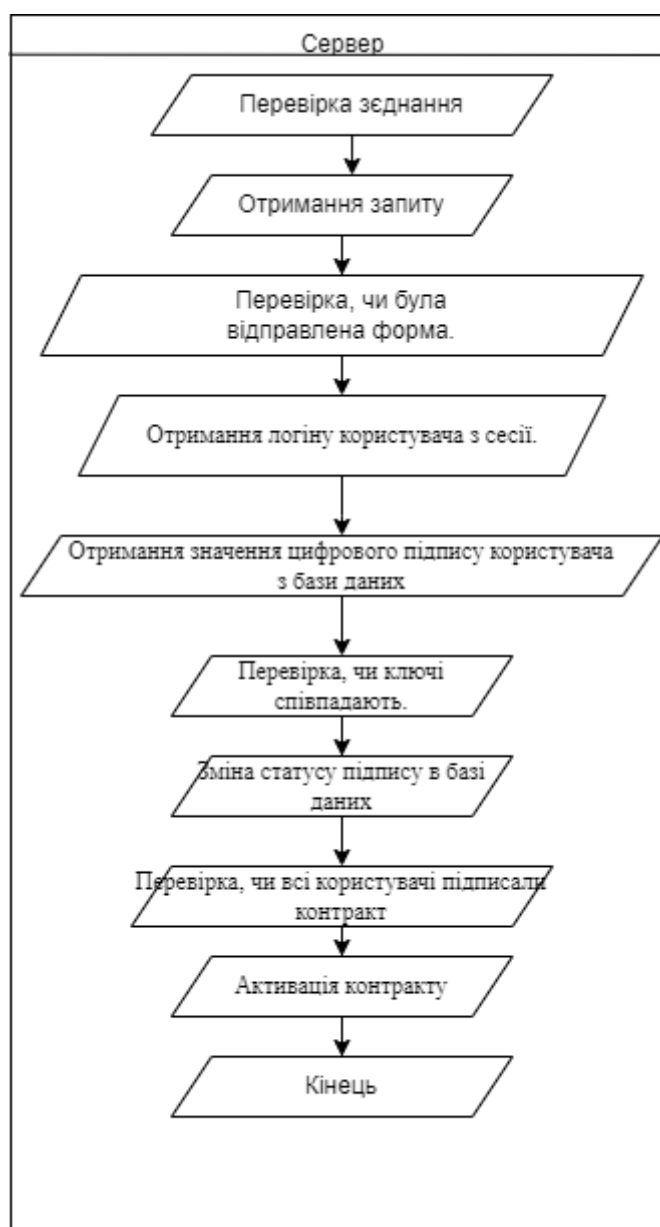
Рисунок 2.5 – блок-схема підпису наявного смарт-контракту
