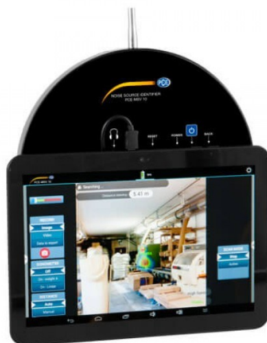
Рисунок 1.2 – Зовнішній вигляд акустичної звукової камери
