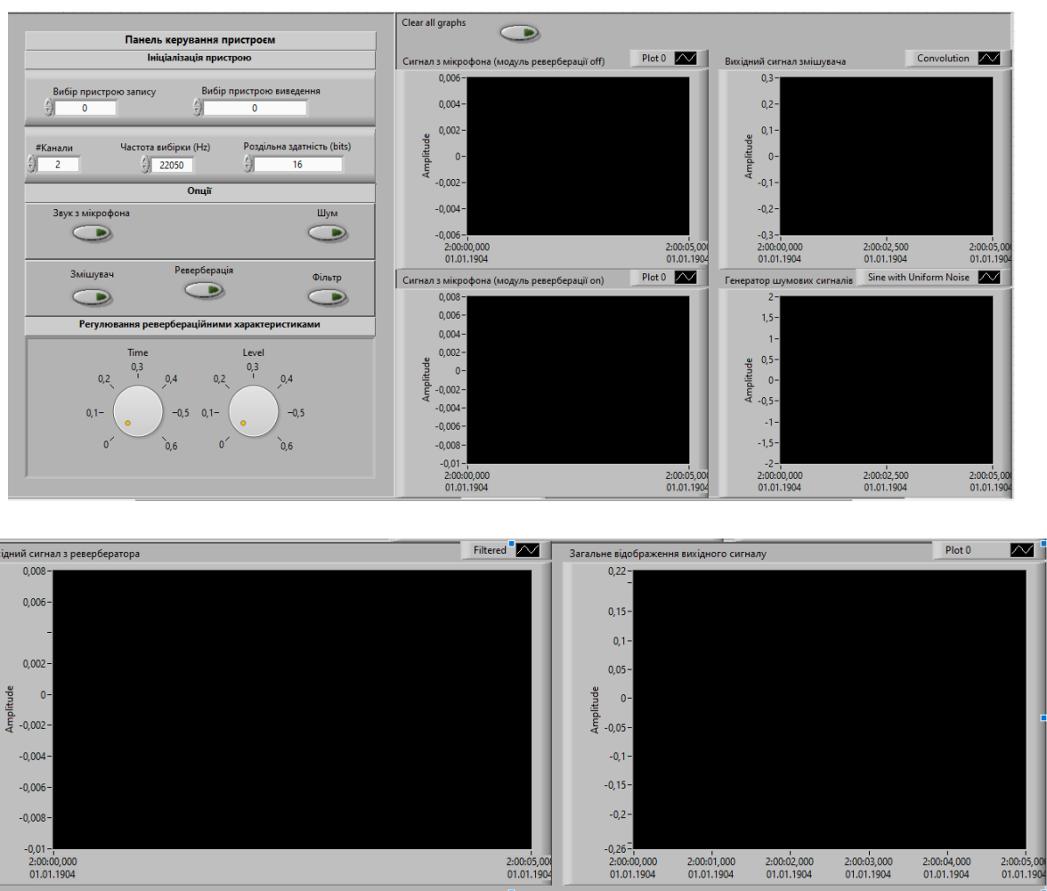
Рисунок 3.12 – Інтерфейс розроблюваного віртуального генератора шумових сигналів
