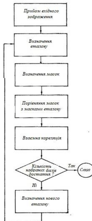
Рисунок 1.3 – Блок схема роботи методу зіставлення з еталоном
