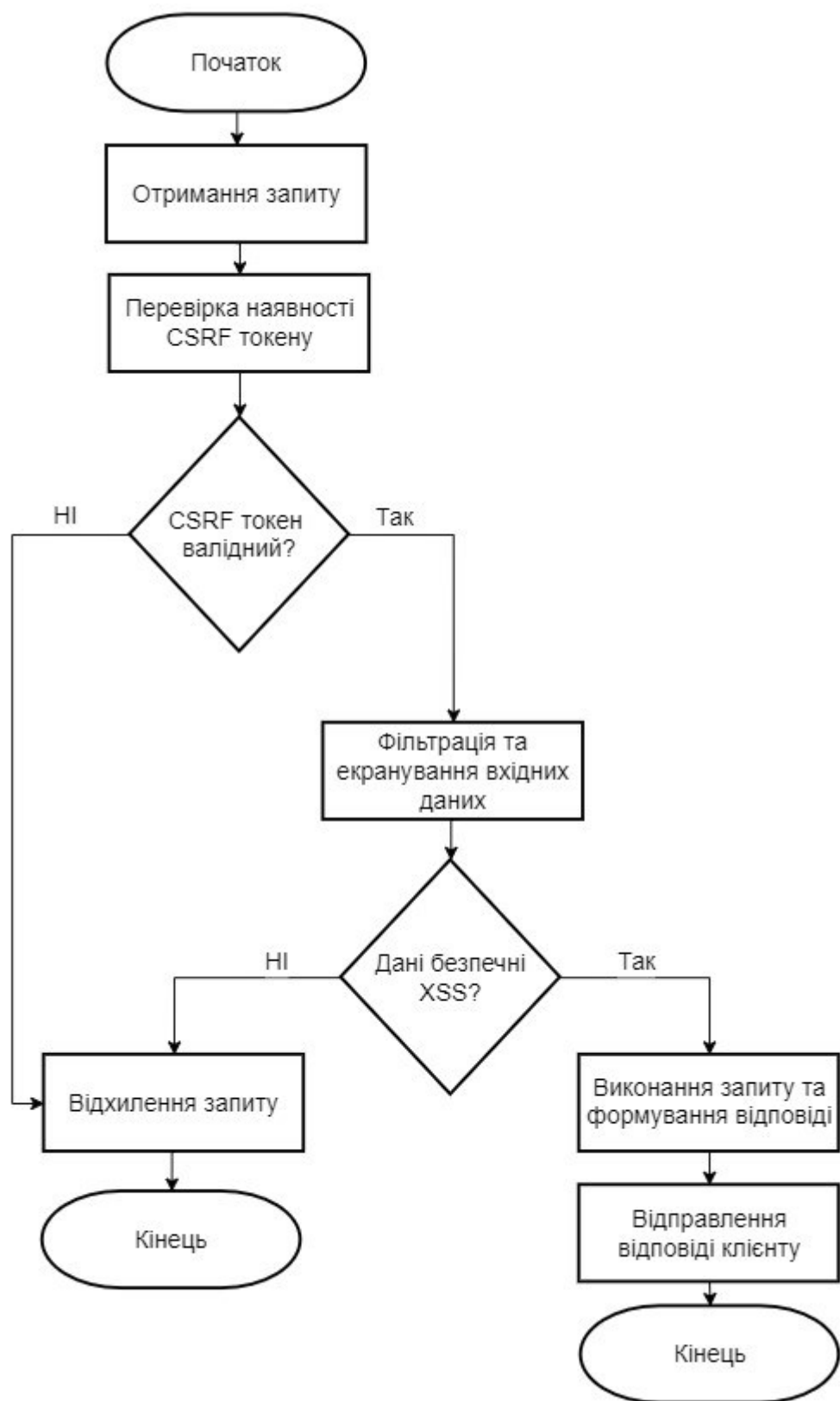
Рисунок 2.2 – Блок-схема алгоритму роботи підсистеми із захисту веб-додатків від атак CSRF і XSS
