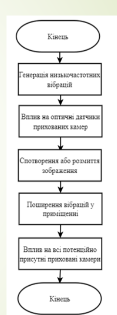
Схема роботи алгоритму розробленого пристрою на 3 етапі
