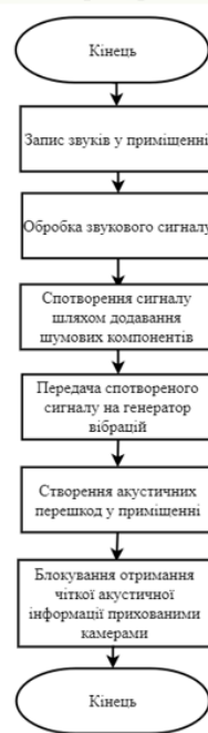
Схема роботи алгоритму розробленого пристрою на 2 етапі
