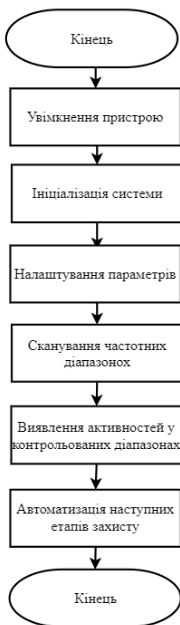
Рисунок 2.2 – Схема роботи алгоритму розробленого пристрою на 1 етапі
