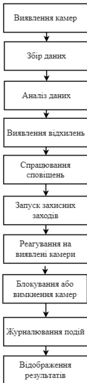
Рис. 1.2 – Загальна схема ПЗ для виявлення прихованих відеокамер
