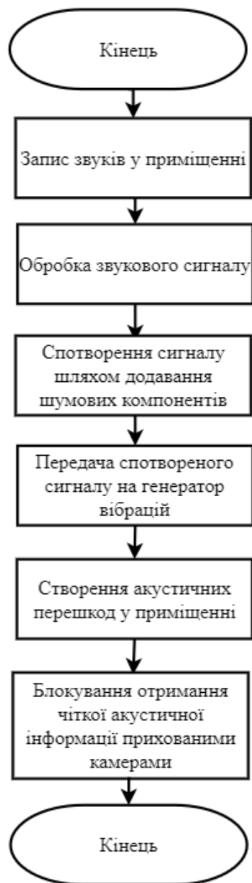
Рисунок 2.4 – Схема роботи алгоритму розробленого пристрою на 3 етапі
