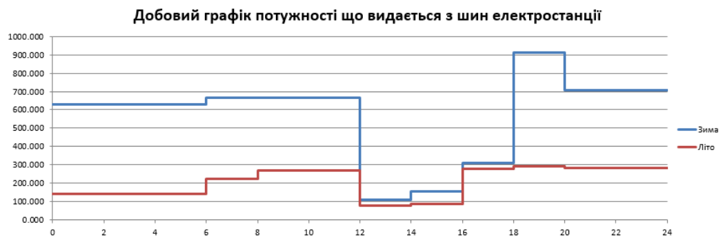
Рисунок А.4 – Графік сумарної потужності, що віддається з шин станції Синій графік – багатоводний режим, червоний графік – низьководний режим
