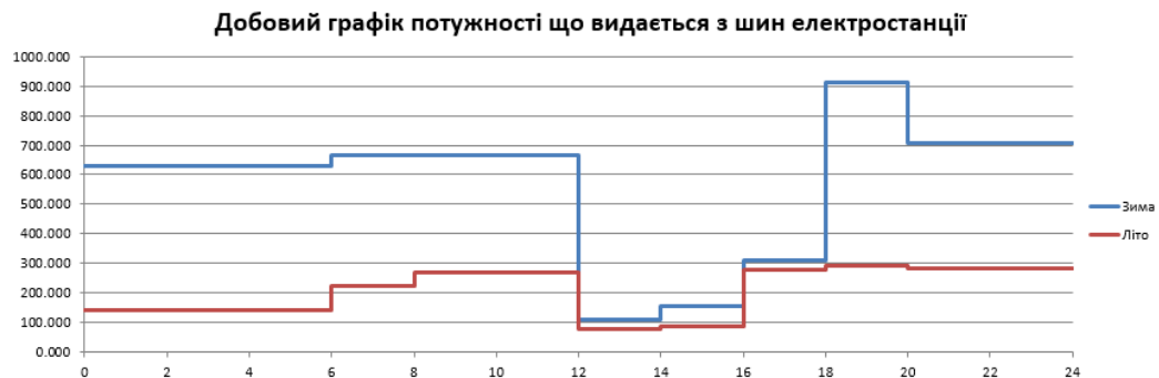
Рисунок 1.3 – Графік сумарної потужності, що віддається з шин станції Синій графік – багатоводний режим, червоний графік – маловодний режим, застосовується до всіх графіків
