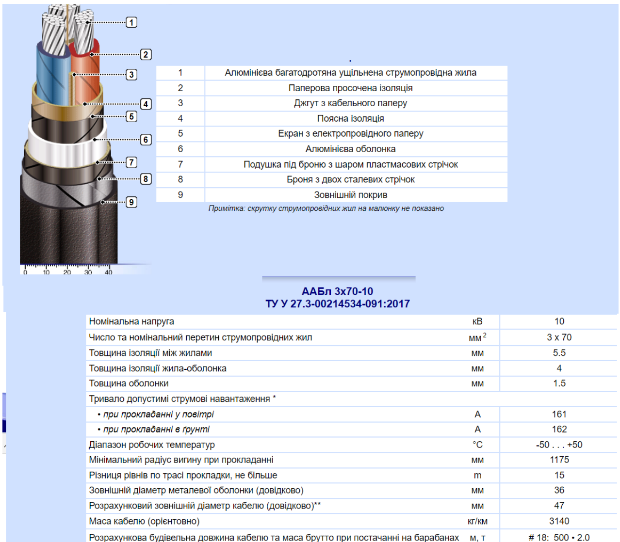
Рисунок 2.3 – Будова та характеристики кабеля
