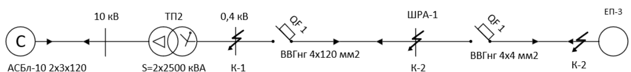
Рисунок 2.6 – Схема електропостачання ЕП-1
