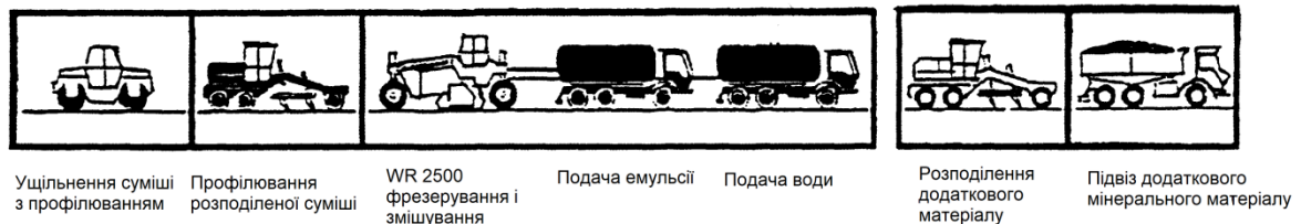
Рисунок 1.8 – Схема робочих процесів та комплект машин для холодного ресайклінгу із застосуванням бітумної емульсії
