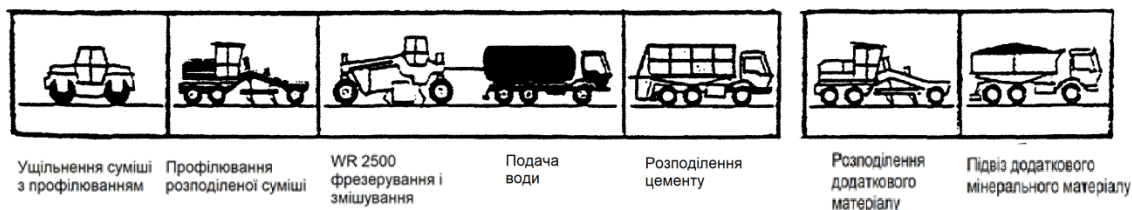
Рисунок 1.9 – Схема робочих процесів та комплект машин для холодного ресайклінгу із застосуванням цементу
