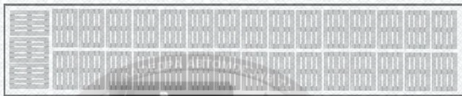
Рисунок 2.4 – Розташування вантажу на піддонах у кузові автомобіля
