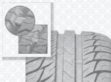
Рисунок 1.4 – Індикатор зносу шини(обведений колом)
