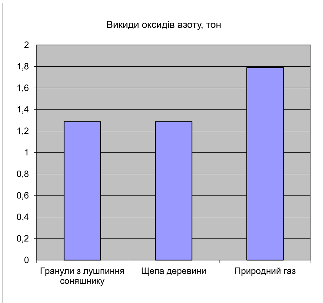
Рисунок 2.2 – Валові викиди оксидів азоту під час спалювання природного газу, щепи деревини та гранул з лушпиння соняшнику
