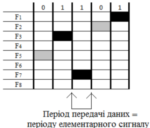
Рисунок 2.6 – Принцип повільної перебудови робочої частоти
