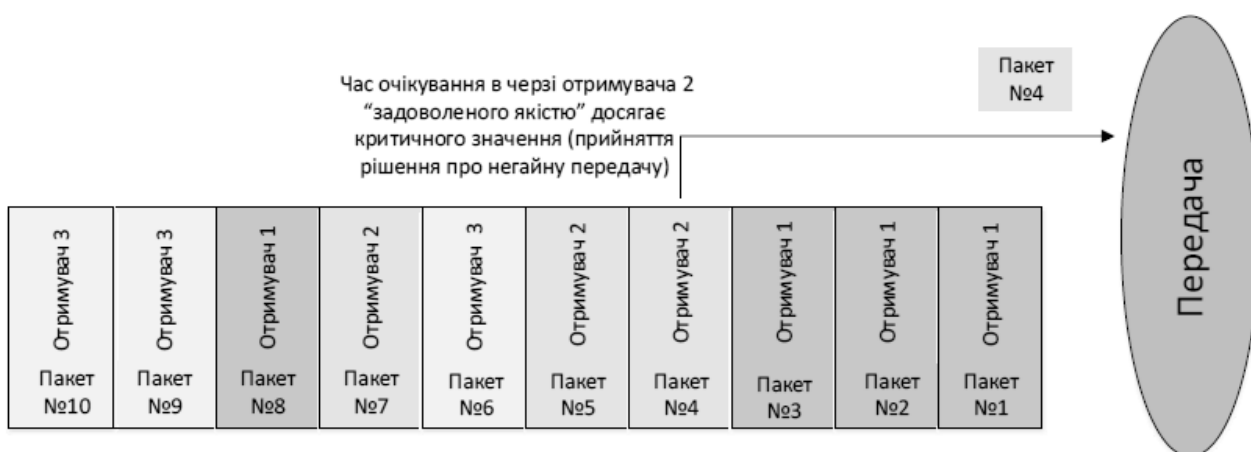
Рисунок 3.3 – Принцип роботи модифікованого алгоритму обслуговування черг
