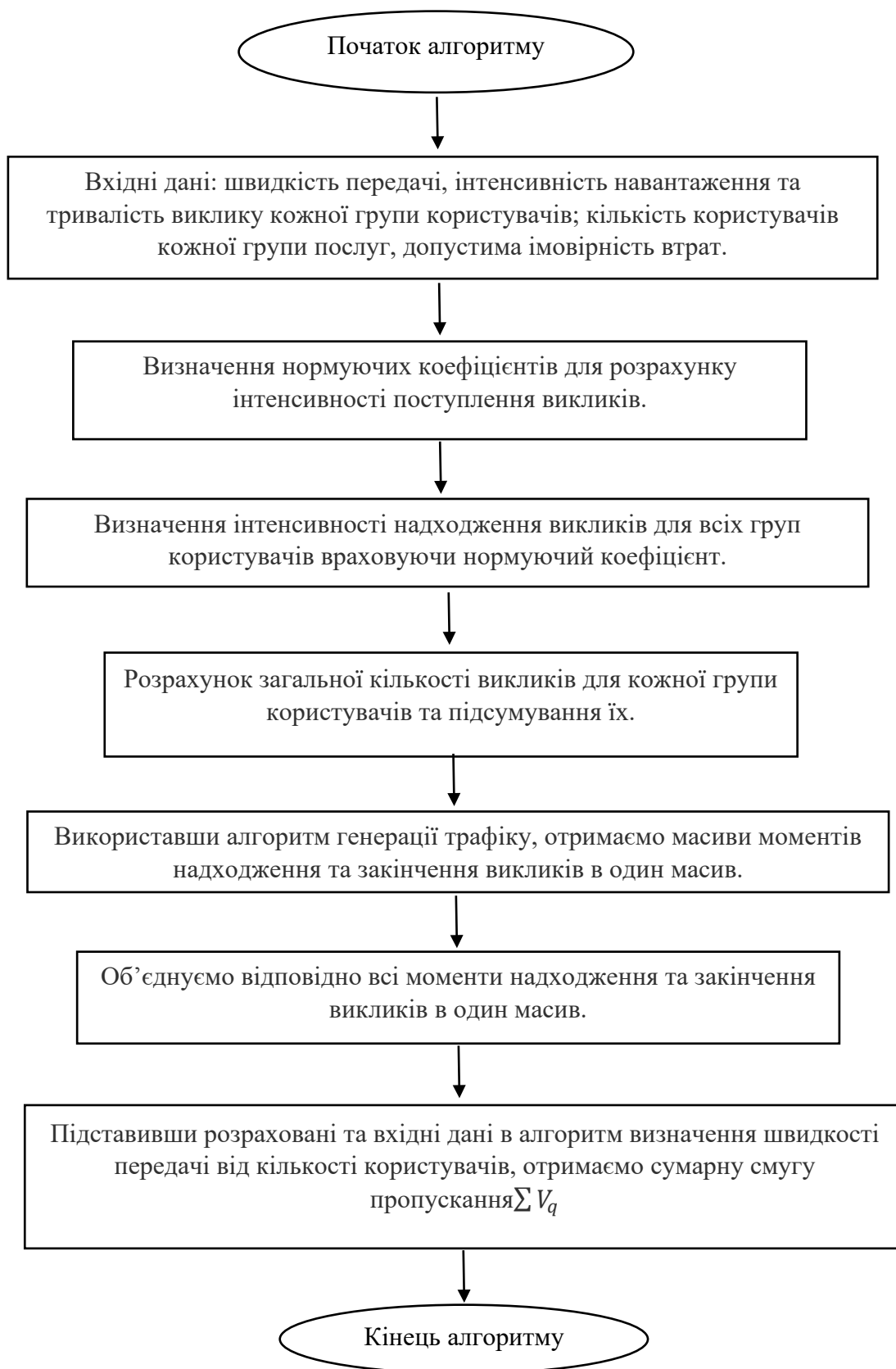
Рис. 3.1 Блок-схема алгоритму визначення швидкості передачі
