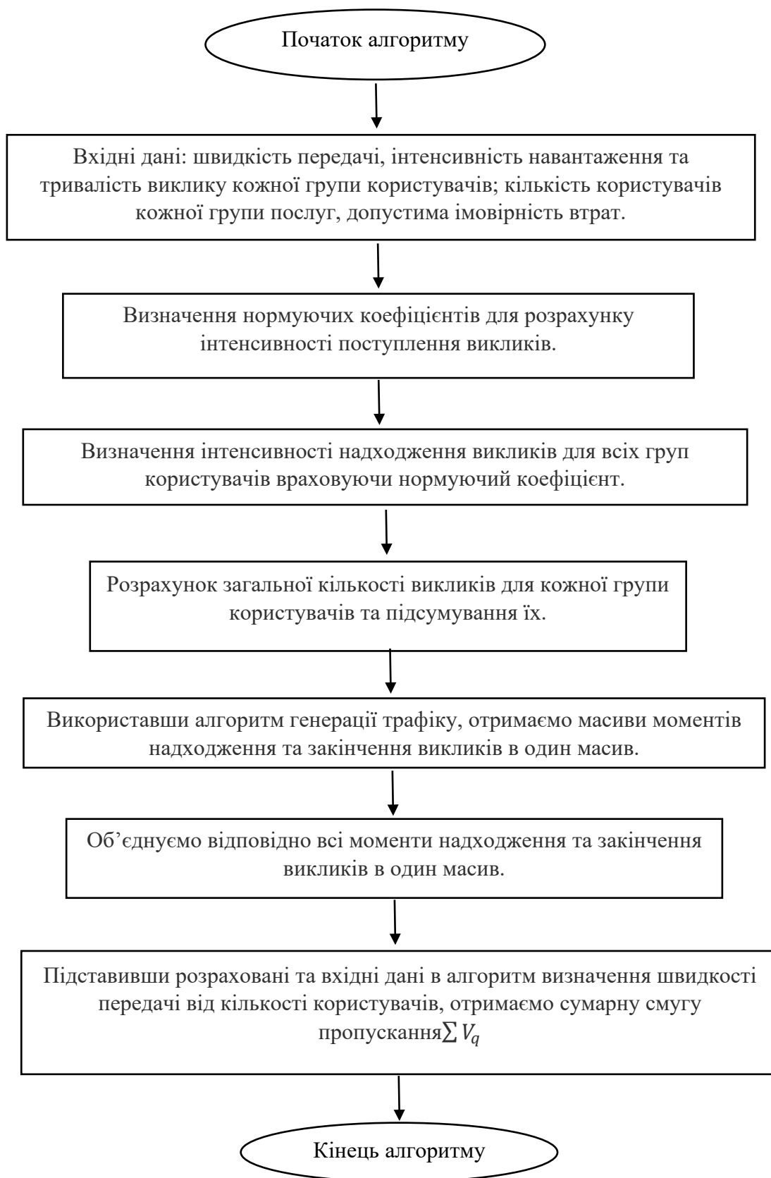
Блок-схема алгоритму визначення швидкості передачі
