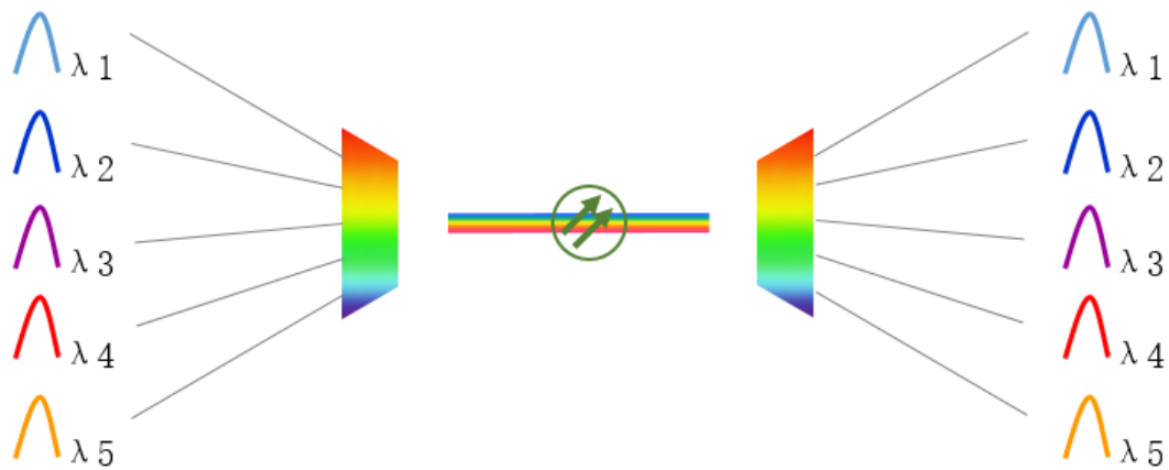
Рисунок 1.10 – Принцип роботи WDM
