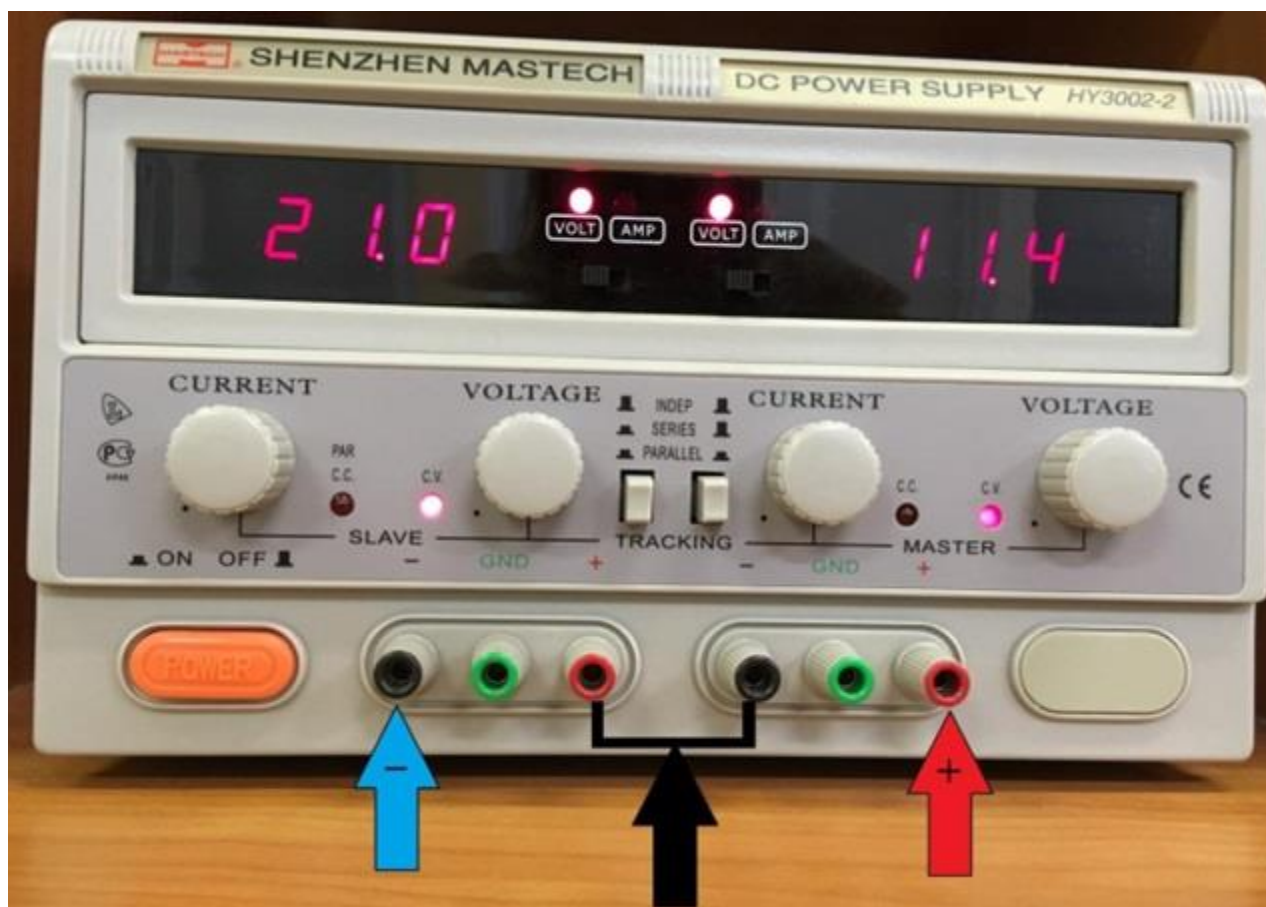
Рисунок 9 – Джерело живлення (стрілками вказані клеми для підключення ОП)
