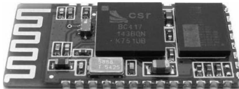
Рисунок 2.7 – Зовнішній вигляд Bluetooth модулів на мікроконтролері BC417143B
