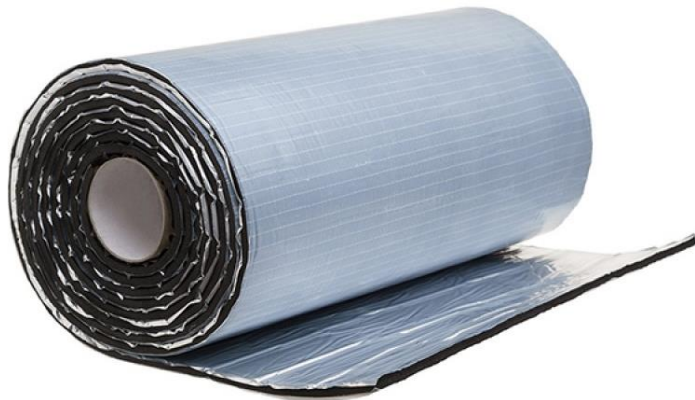
Рис. 2.2 – Багатошаровий самоклеючий матеріал із спеціальної високоміцної алюмінієвої фольги, синтетичного спіненого каучуку, мембрани на основі бутилкаучуку, клейового шару високої липкості з армувальною сіткою
