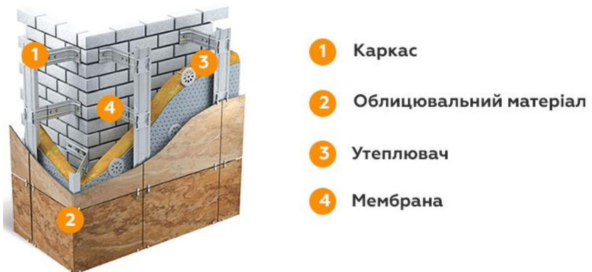
Рисунок 4.2 – Фрагмент системи вентиляльованого фасаду
