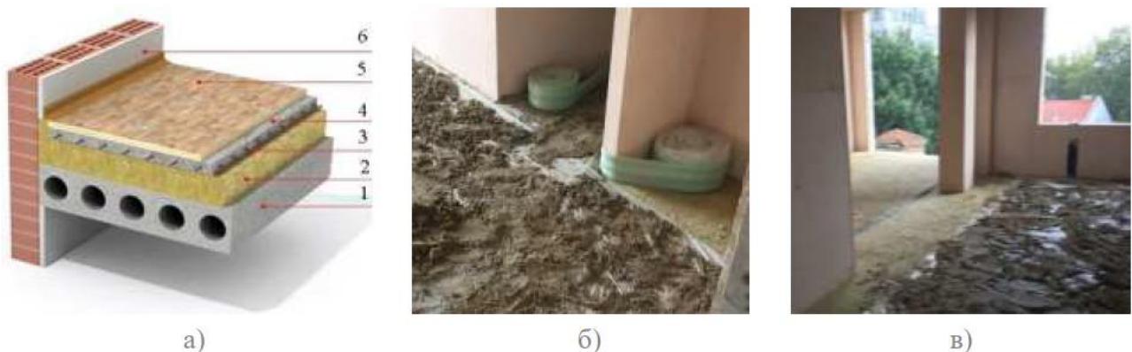
Рисунок 1.4 – Влаштування «плаваючої» підлоги з використанням акустичної вати: а) схема перекриття: 1 – плита перекриття; 2 – акустична вата; 3 – гідропароізоляція; 4 – демпфуюча стрічка; 5 – армована стяжка; 6, 7 – стіна; б) влаштування демпфуючої стрічки; в) влаштування акустичної вати, шару гідроізоляції
