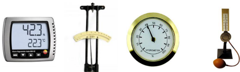
Рисунок 2.6 – Види гігromетрів: а) електронний, б) волосний, в) керамічний, г) конденсаційний
