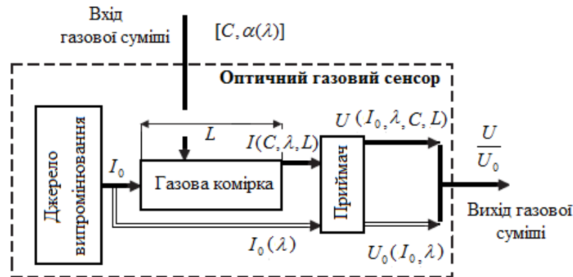
Рисунок 3.5 – Структурна схема розробленого оптичного газового сенсора
