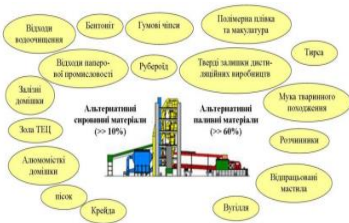
Рисунок 2.3 Альтернативні матеріали, що застосовуються на заводі комбінованого способу виробництва цементу в Lägerdorf (Німеччина).
