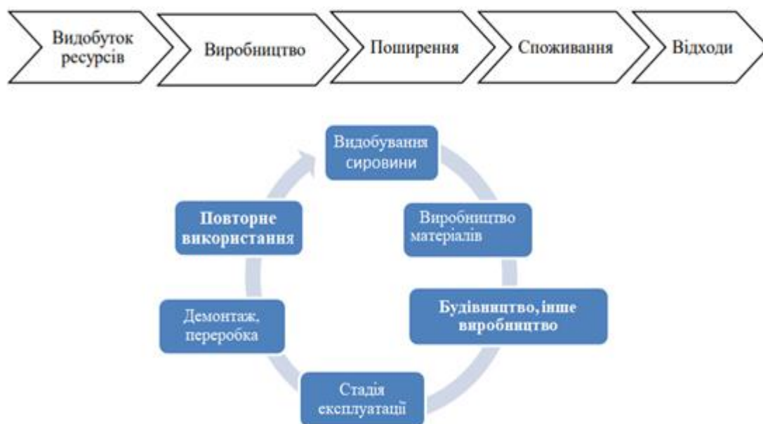
Рисунок 2.1 Життєвий цикл будівель та споруд в умовах лінійної та циркулярної економіки.
