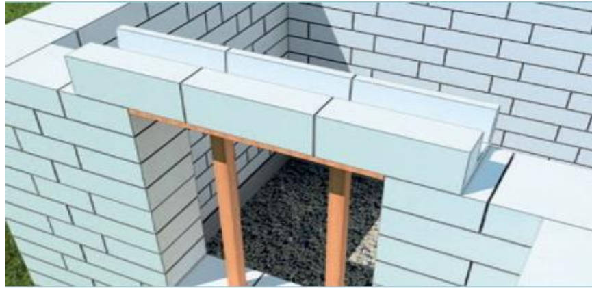
Рисунок. 2.6 – Фрагмент влаштування збірно-монолітної перемички з газобетонних U-блоків на реальному об'єкті.
