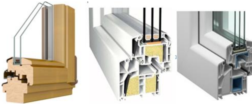
Рисунок 3.12 Заповнення камер віконного профілю спіненими або твердими утеплювачами
