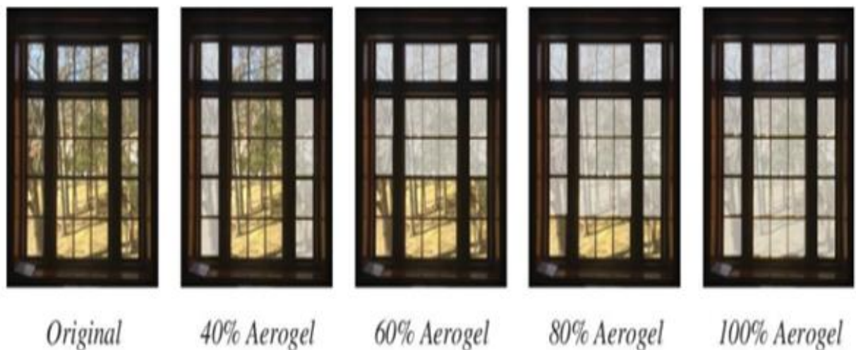
Рисунок 4.3 Фрагмент вікон з використанням аерогелю.
