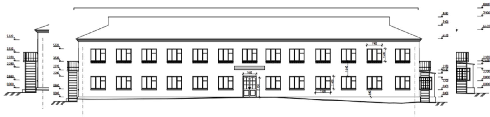
Фасад в осях 1-2
