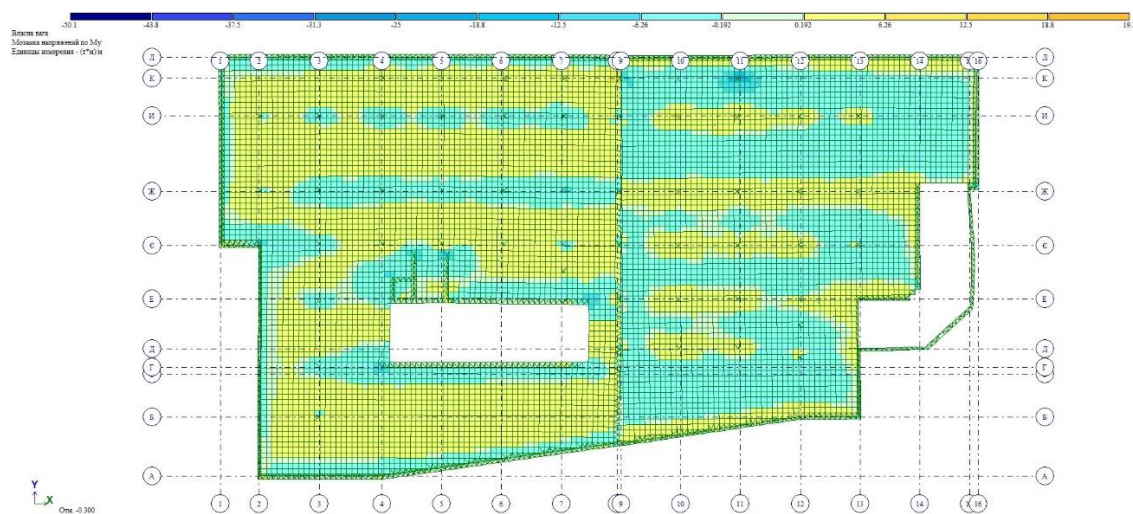
Рисунок 2.6 – Мозаїка напружень по M_y
