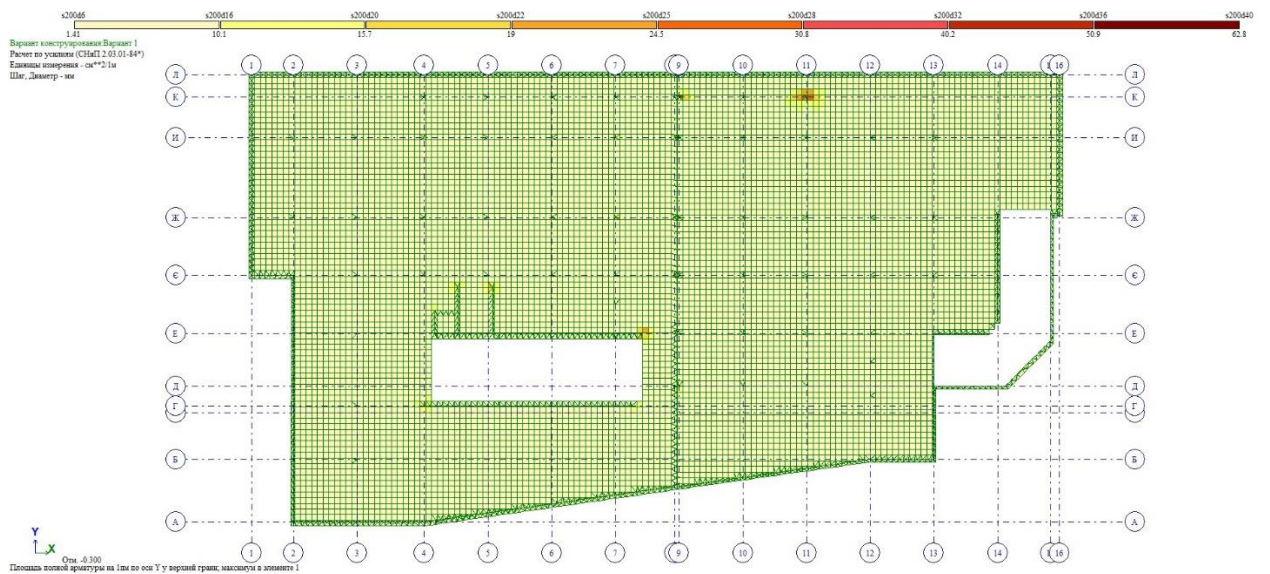
Рисунок 2.11 – Площа арматури на 1 п. м по осі Y верхній грані
