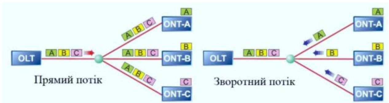
Рисунок 1.6 – Структура передачі нисхідних та висхідних потоків у PON
