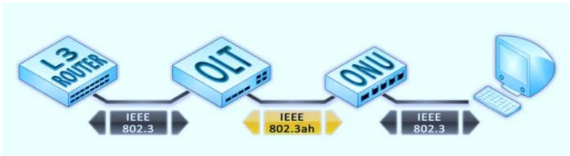
Рисунок 1.7 – Процес перетворення пакетів у мережі PON
