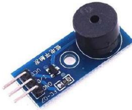
Рисунок 2.20 – Вигляд модуля п'єзодинаміка
