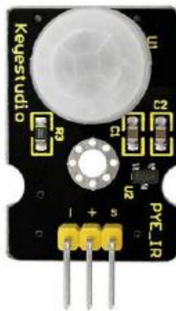
Рисунок 2.15 – Вигляд модуля давача руху типу PIR HC-SR501
