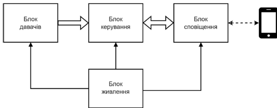
Рисунок 2.12 – Узагальнена структурна схема радіоелектронного пристрою охоронної сигналізації з GSM каналом
