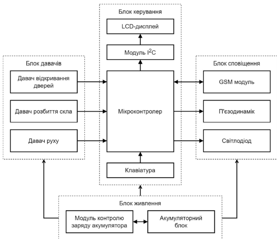
Рисунок 2.13 – Деталізована структурна схема радіоелектронного пристрою охоронної сигналізації з GSM каналом
