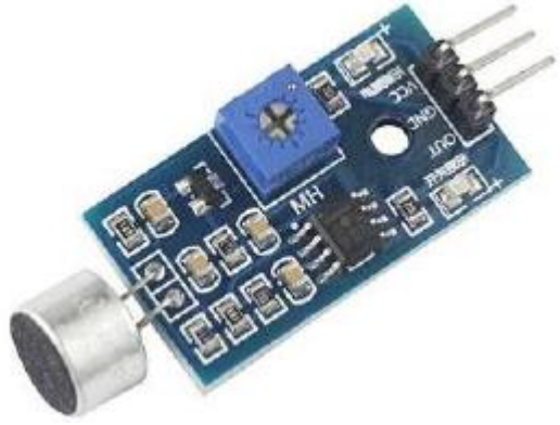
Рисунок 2.17 – Вигляд модуля давача розбиття скла типу KY-037
