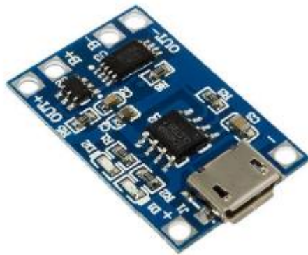
Рисунок 2.19 – Вигляд модуля контролю заряду-розряду АКБ типу TP4056
