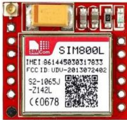
Рисунок 2.18 – Вигляд GSM модуля типу SIM800L
