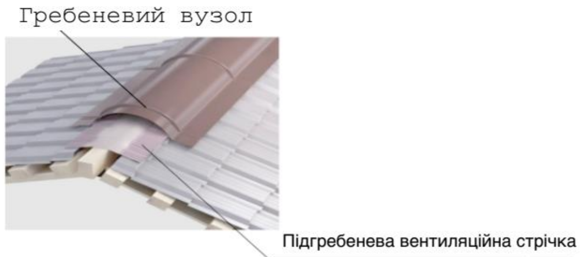
Рисунок 3.9 – Облаштування вентиляції гребеневого вузла вентиляційною стрічкою
