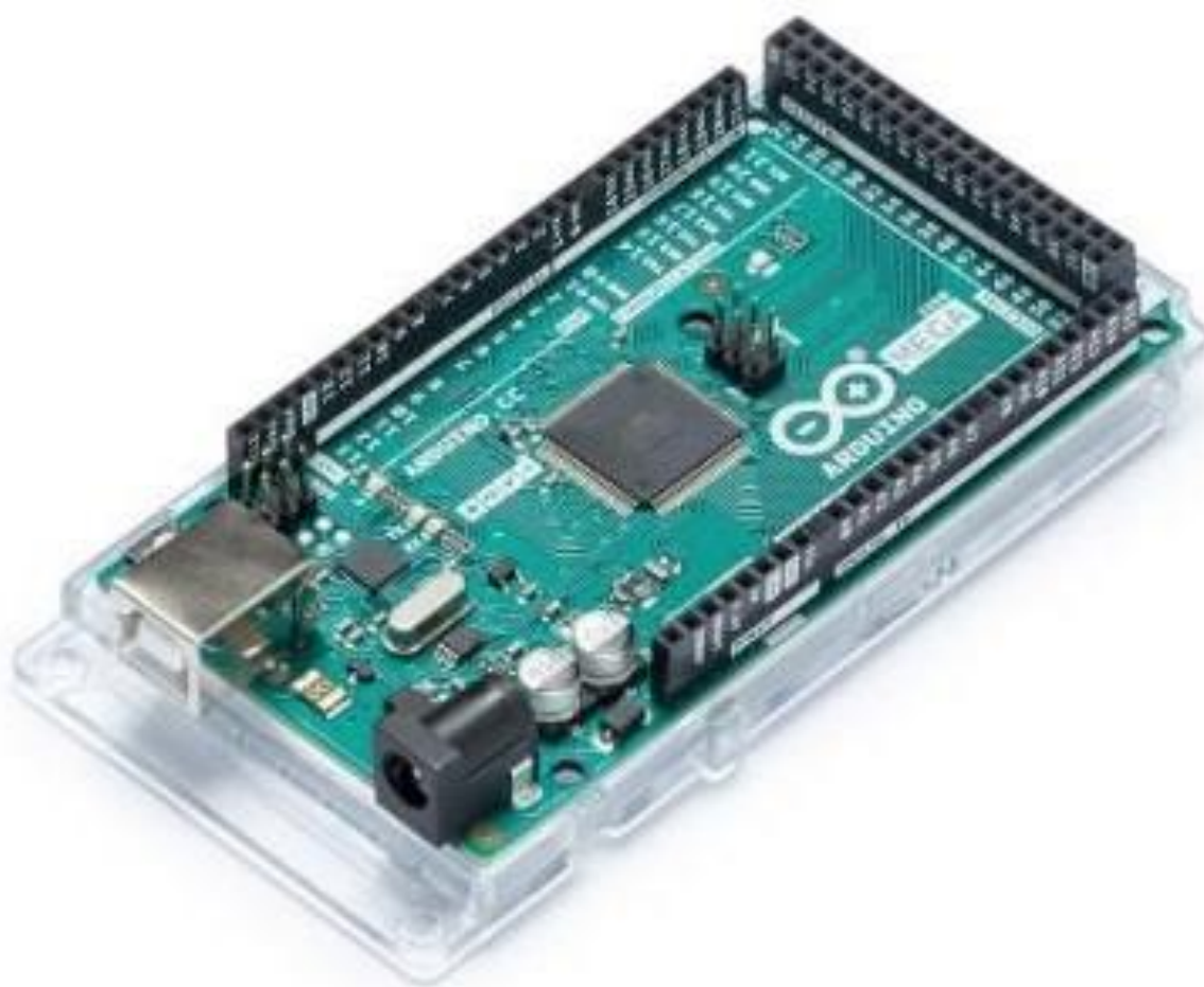
Рисунок 2.3 — Платформа Arduino Mega 2560
