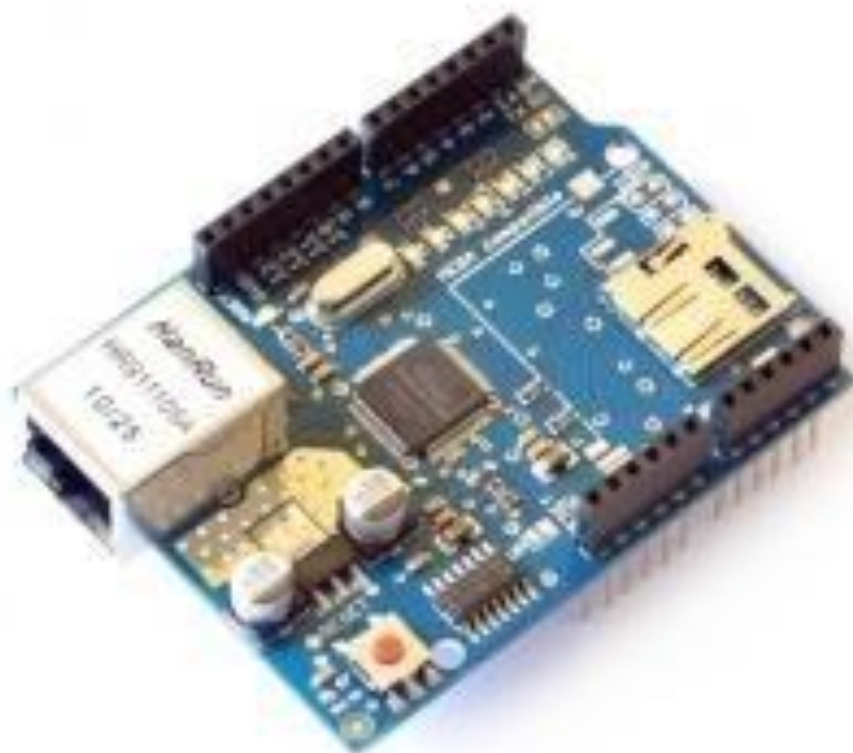
Рисунок 2.4 — Плата Ethernet Shield W5100
