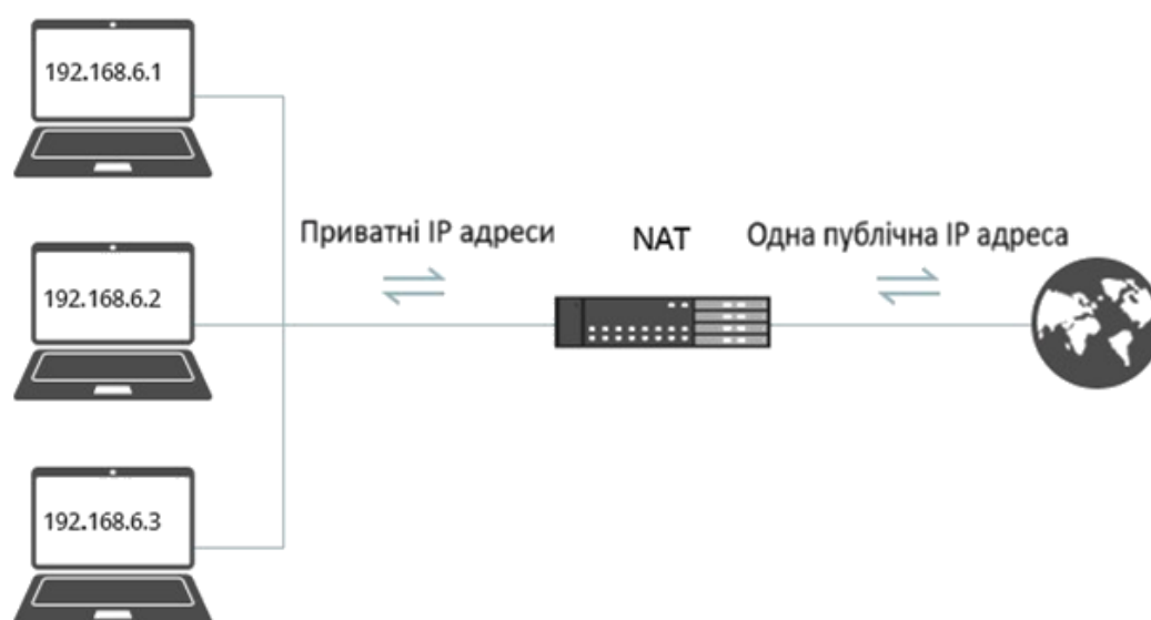
Рисунок 1.3 — Взаємодія локальних та публічних IP-адрес за допомогою технології NAT
