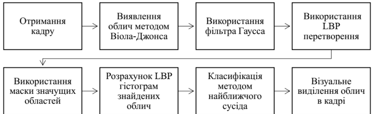
Рисунок 3.1 – Алгоритм, що використовується для обробки послідовних кадрів у відеопотоці
