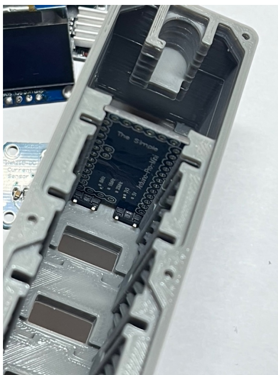
Рисунок 2.16 — Розміщення плати Arduino у корпусі
