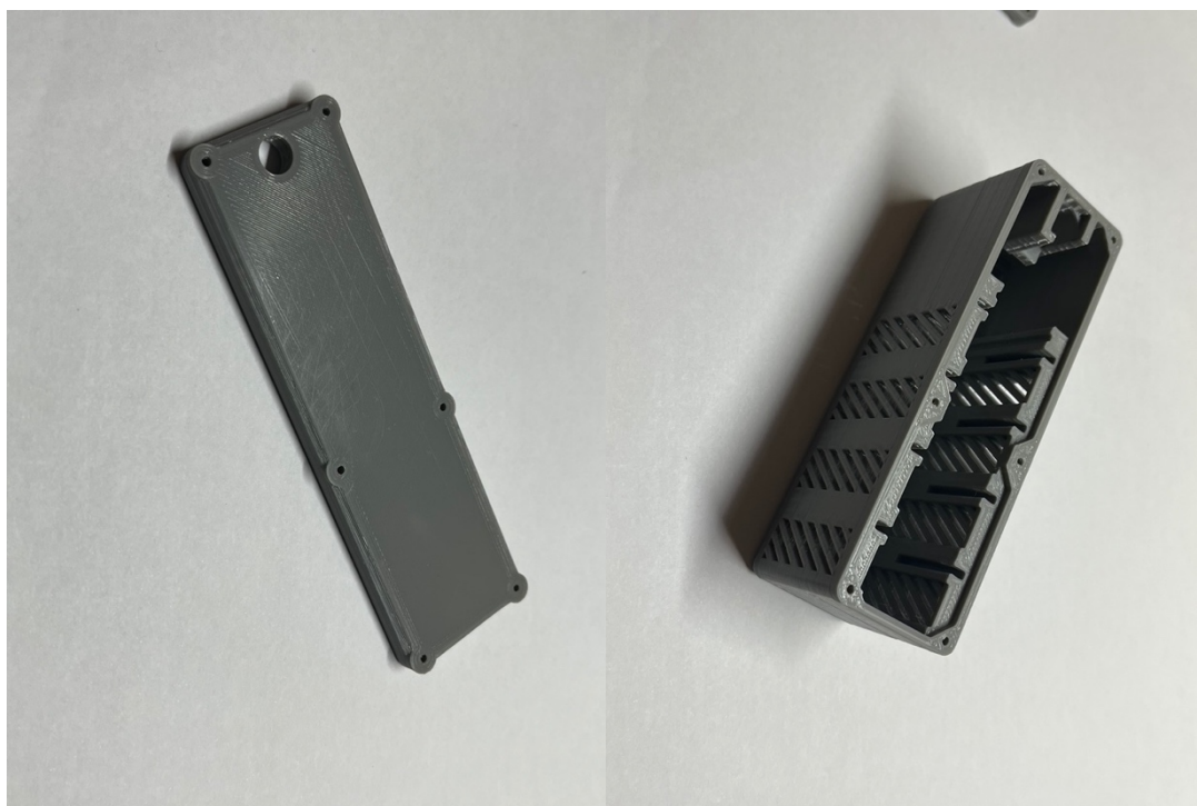
Рисунок 2.14 — Основна частина корпус та кришка, надруковані на 3D принтері
