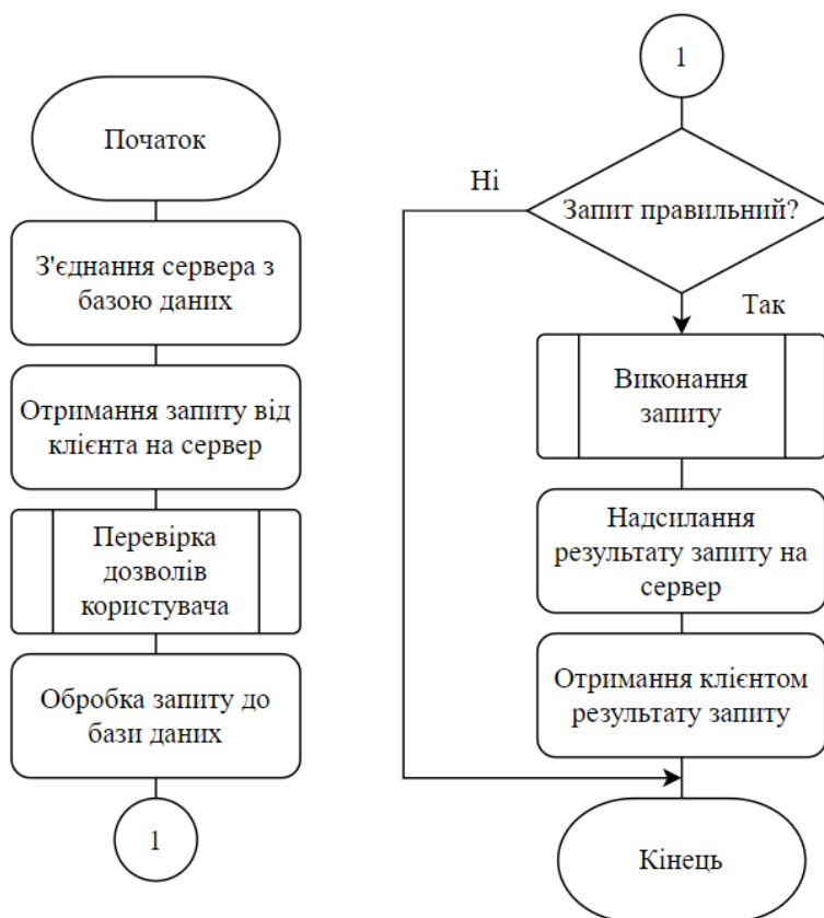
Рисунок 3.4 – Алгоритм роботи модуля взаємодії з базою даних
