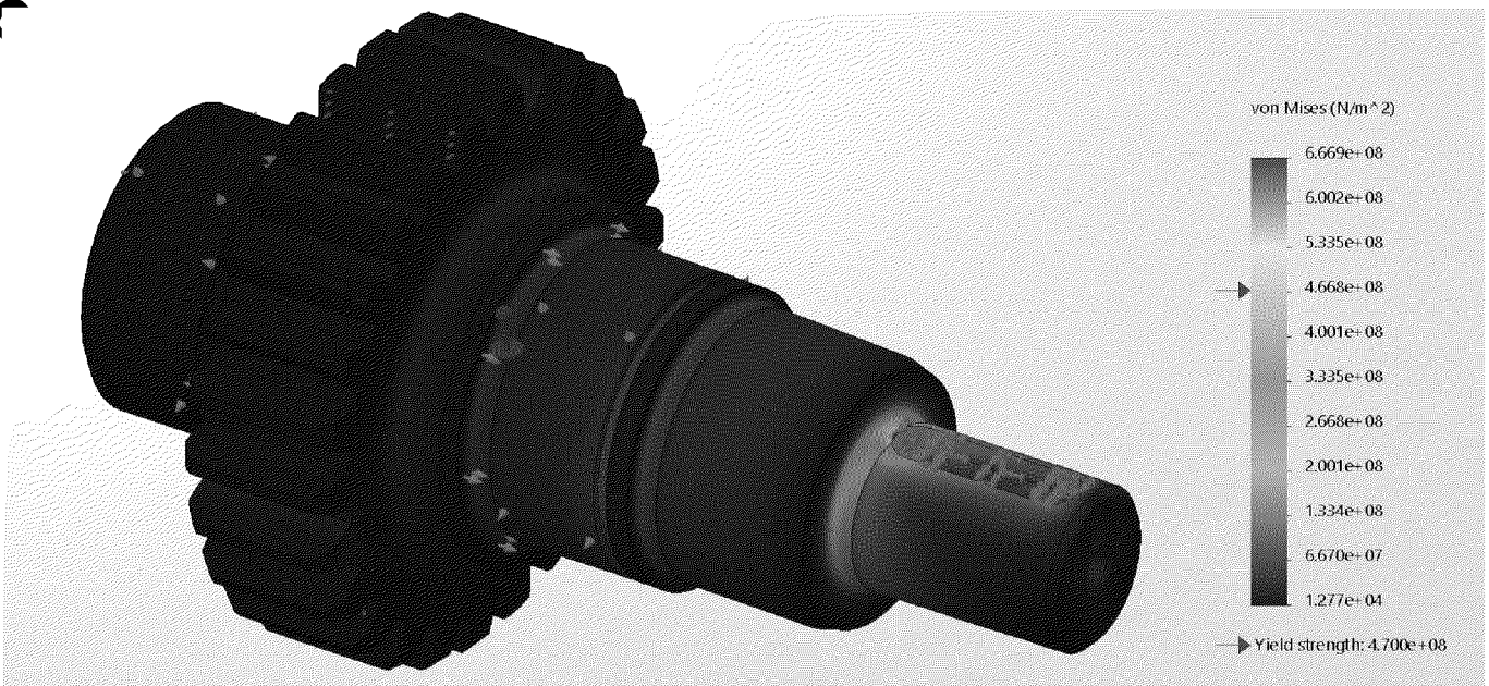
Рисунок 1.6 – Напруження по Мізсу для деталі «Вал-шестерня Д02210.5»
