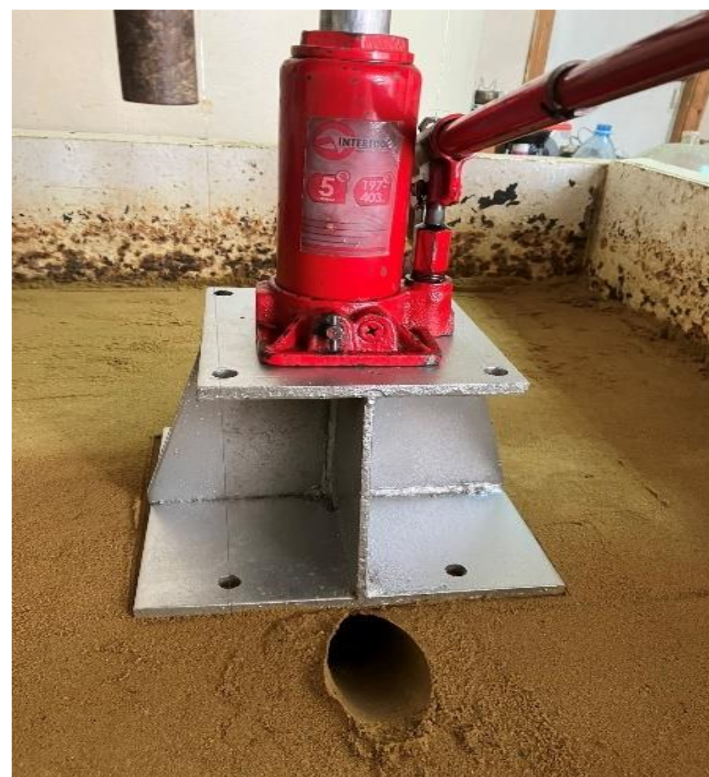
Армування ґрунтової основи жорстким матеріалом
