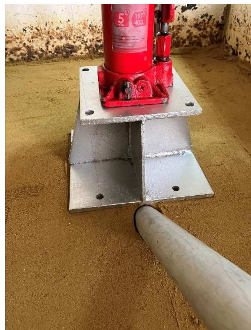
Армування ґрунтової основи жорстким матеріалом
