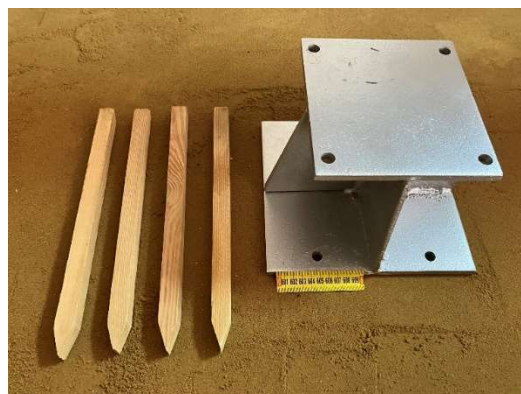
Рис. 2.2 – Моделі паль та ростверка
