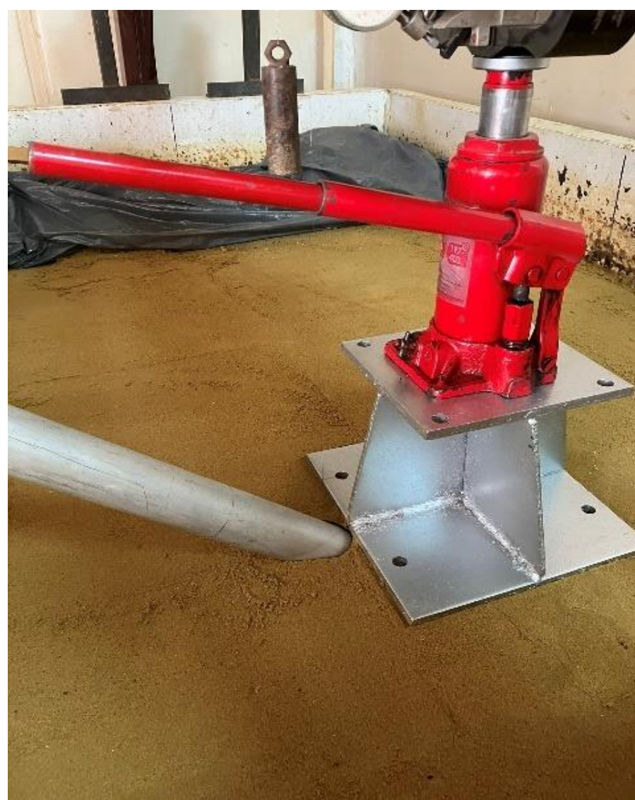
Армування ґрунтової основи жорстким матеріалом
