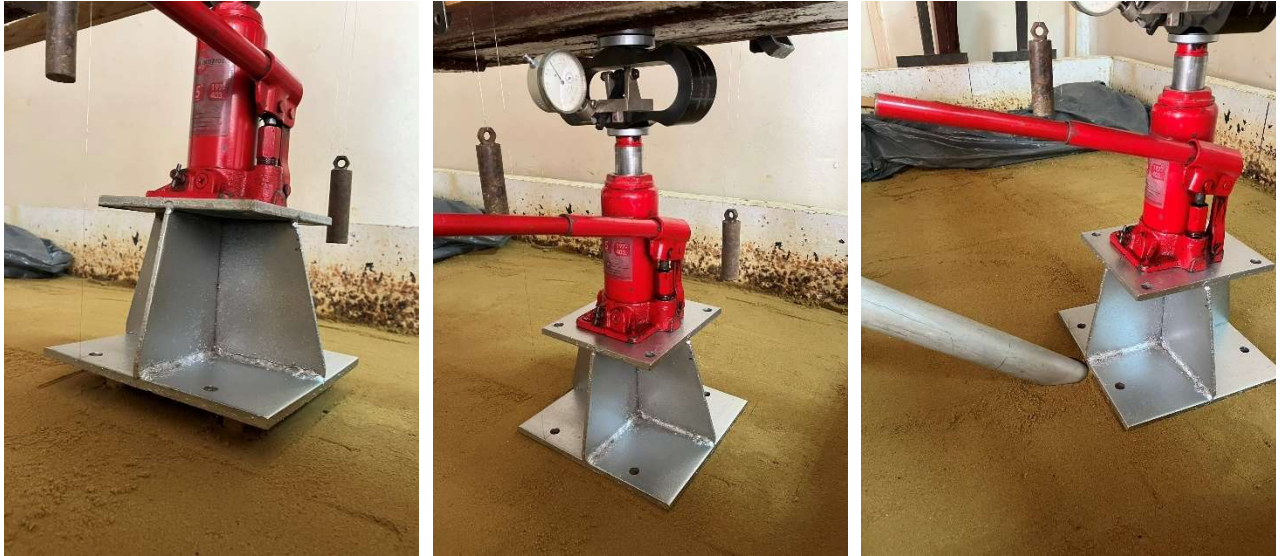
Рис. 2.6 – Процес випробування пальового фундаменту
