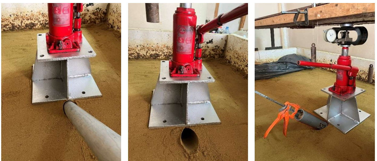
Рис. 2.7 – Армування ґрунтової основи жорстким матеріалом
