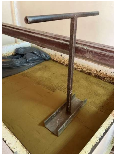
Рис. 2.1 – Лоток з ущільненим піском, що імітує ґрунтову основу
