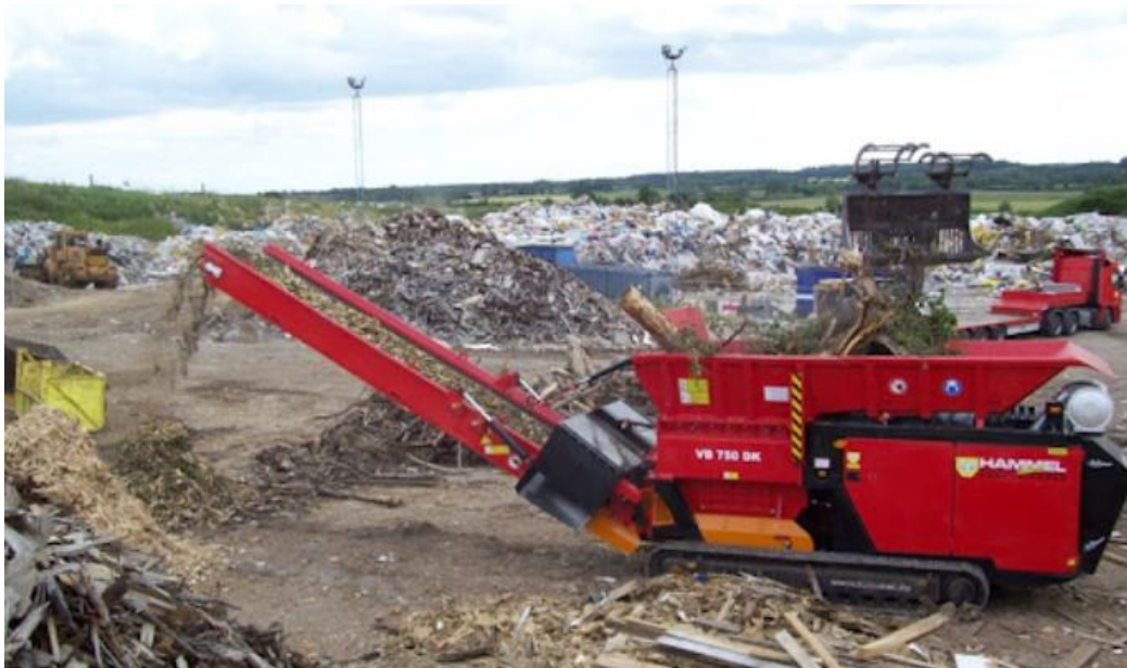
Рис. 1.28 – Дробильний комплекс HAMMEL
