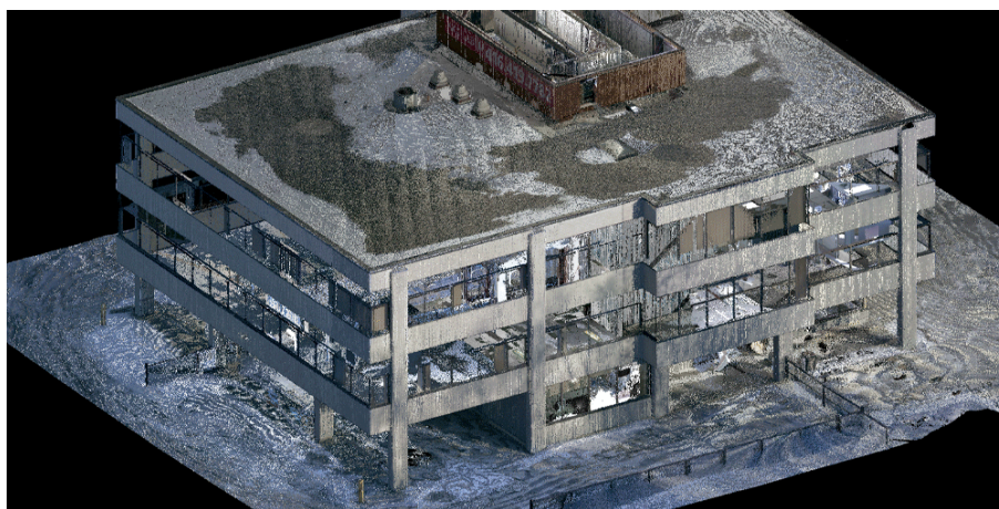
Рисунок 2.4 – Модель будівлі на основі просторового лазерного сканування
