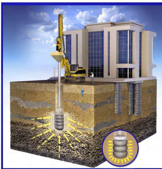
Рис. 1.6 - Щебенева паля типу Geopier
