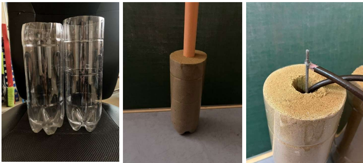
Рис. 2.8 – Підготовка ґрунтового лотка до випробувань
