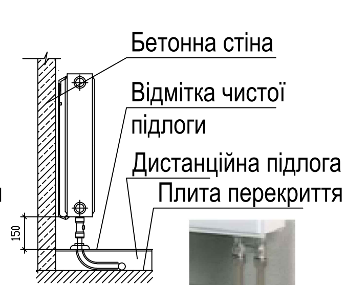
Схема кріплення радіаторів до стіни (відступ від конструкції стіни до радіатора приймаємо 40 мм)
