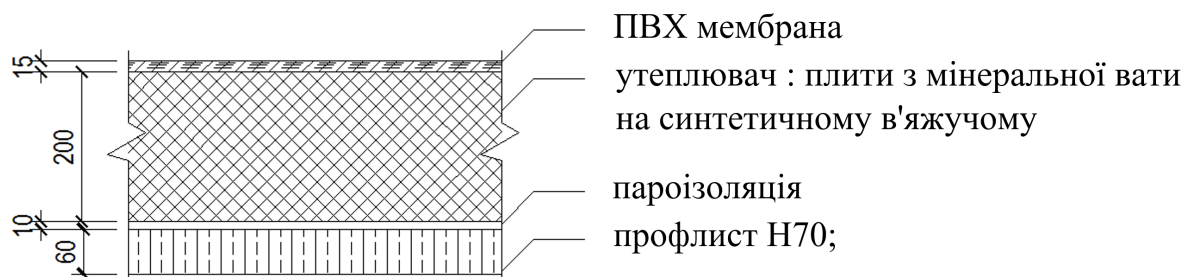
Рис. 2.2 – Конструкція покрівлі: ПВХ мембрана; утеплювач: плити з мінеральної вати на синтетичному в'язучому; пароізоляція; профлист Н70.
