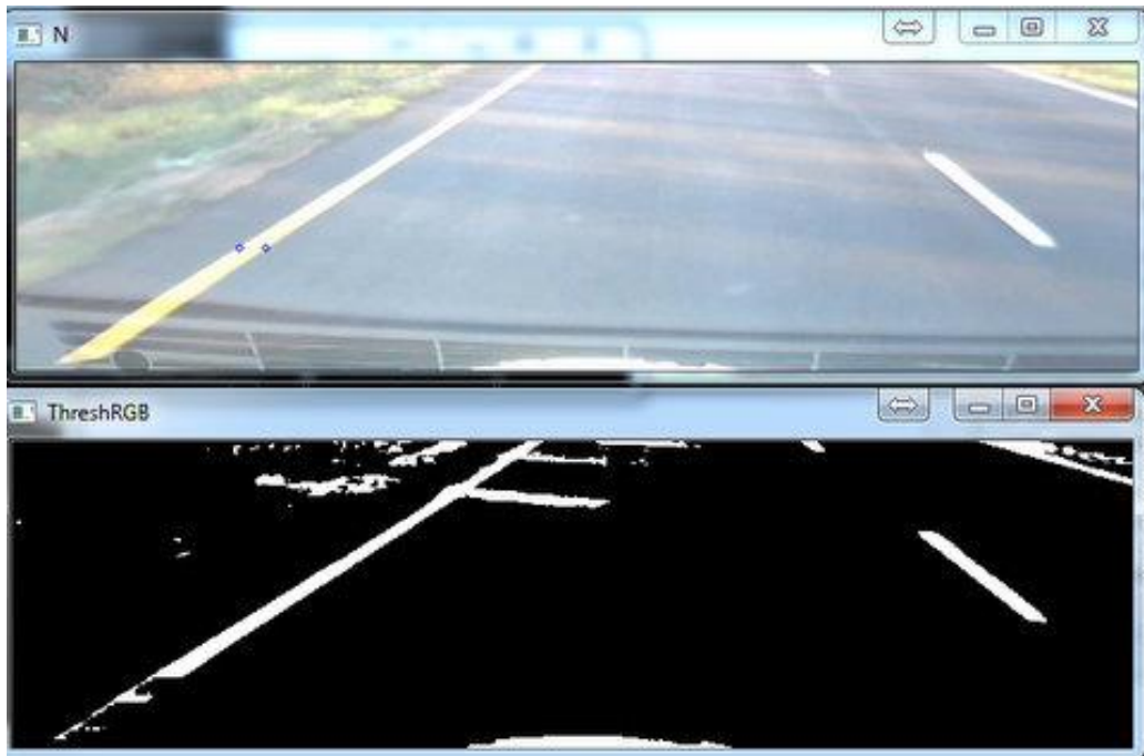
Рисунок 3.2 - Визначення лінії від фону із тіней
