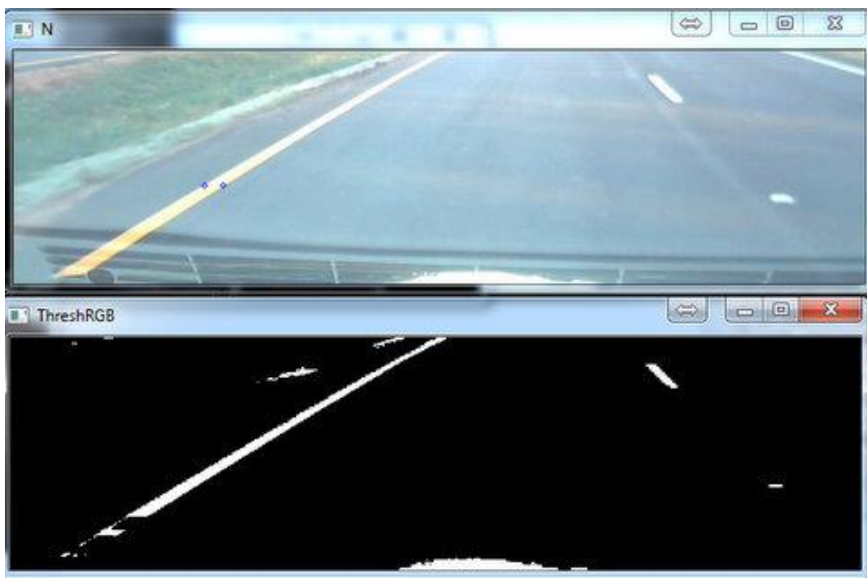
Рисунок 3.1 — Відокремлення лінії від фону
