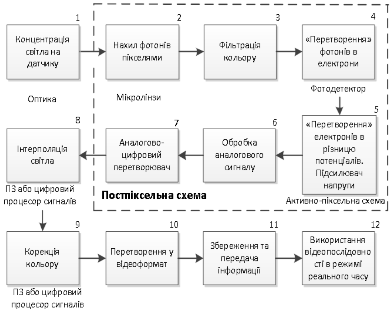
Рисунок Г1 —Схема електрична структурна системи
