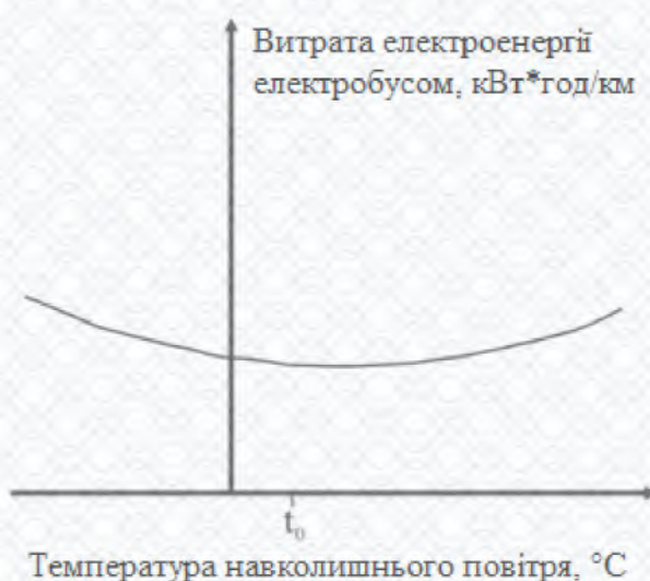
Рисунок 2.5 – Вплив температури навколишнього повітря на витрату електроенергії електробусом
