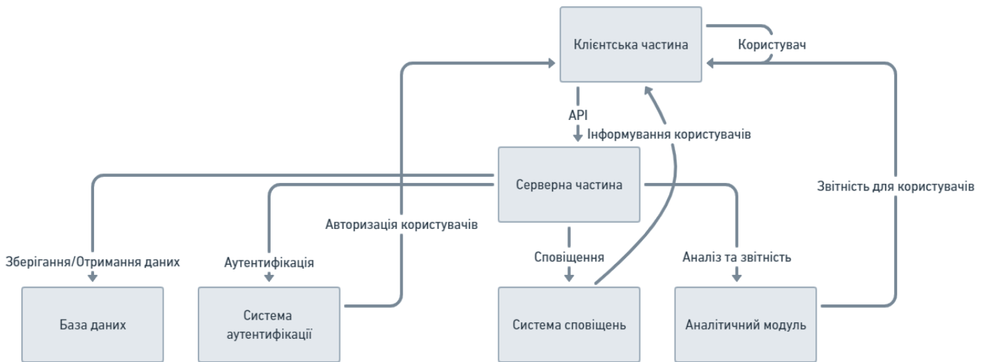
Рисунок 1.1. – Діаграма структури компонентів експертної системи
